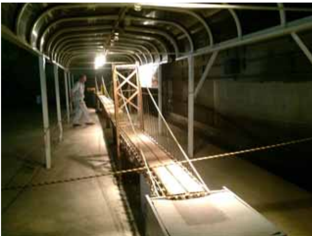
建設前に風洞実験に使用した橋梁模型。
