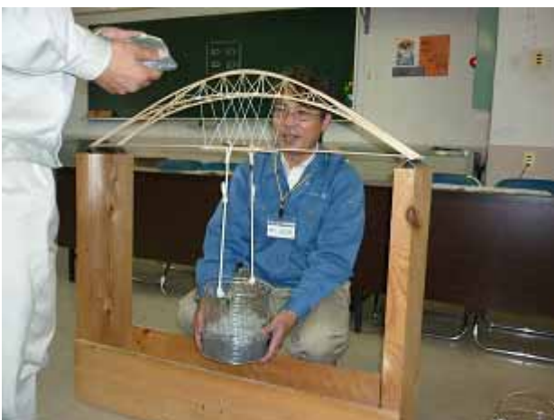
佐野弘治君の作品は、デザイン性においてどの審査員も絶賛しており、耐荷力についても最も期待されていた。山岡先生も自信を持って 17kg まで一気に载荷。
