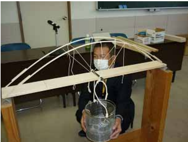
永澤祐太君の作品は、5kg の载荷による補剛桁のたわみで斜材とアーチ部材の接合がはずれた。
