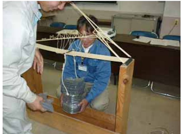
17kg は楽にクリアするはずであったが、上段アーチ部材と下段アーチ部材を端部で重ねて接着していた箇所が剥がれてしまった。
